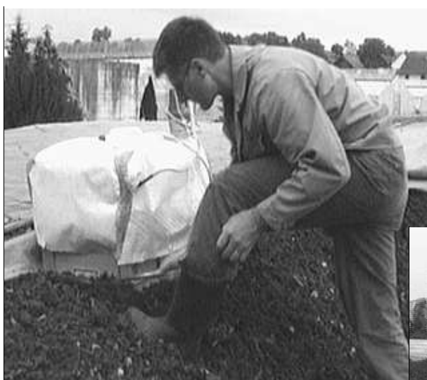
Abb. 35 ( links): Die Messkammer wird mit Kompost gegen Falschluf- teintritt abgedichtet
