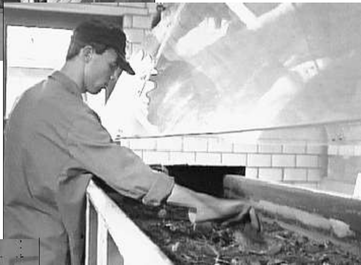
Abb. 14: Das Gärgut wird abgepresst, nachgerottet und anschließend vorwiegend offen an die Landwirtschaft abgegeben.
